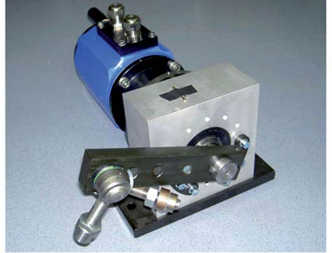
Oden P220R, "Hävvarmsmodul" Anpassningsbar för många olika applikationer.
