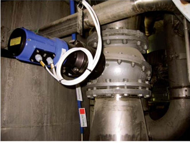
Oden P500R, Ytviktsreglering på Stora Enso Skutskär pappersbruk.
